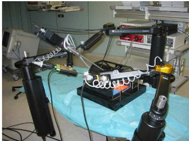
FIG. 1.6 – Robots de télémanipulation du système Zeus.
