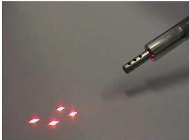
FIG. 2.3 – Spots laser projetés par le porte-outil.
